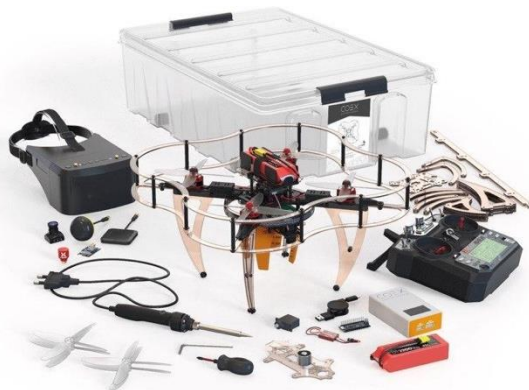
Учебный набор квадрокоптера по компетенции «Эксплуатация беспилотных авиационных систем "COEX Клевер 4 WorldSkills Russia"»
